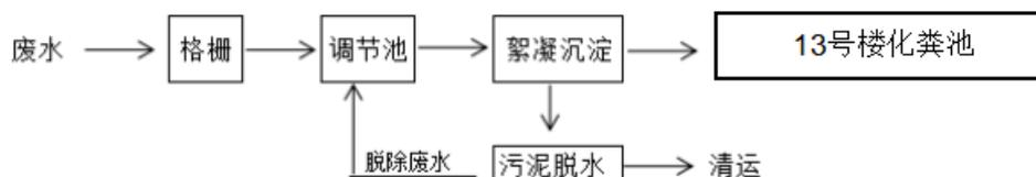
项目水处理工艺流程图
